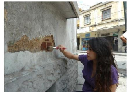
Figs. 1, 2 y 3 Mediciones y tomas de muestra para análisis de aplanados.
