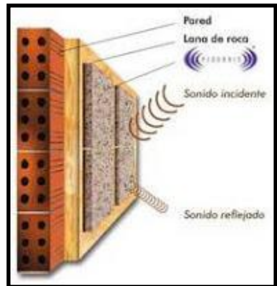
Grafica E48 Aislamiento Acústico en muros Fuente: Centro de Convenciones, Universidad Autónoma Tajarilla, México.
