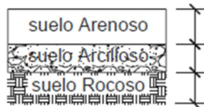
Los edificios cortos se acomodan más fácilmente a las ondas, y el movimiento irregular se manifiesta de igual manera en todos sus apoyos a diferencia de un edificio largo. Por lo tanto es importante Identificar las diferentes capas que componen el suelo componentes, así como las propiedades del mismo como fricción, cohesión, permeabilidad, etc. para poder así diseñar la estructura del edificio.
