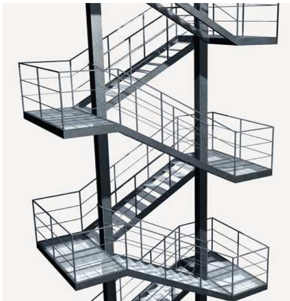
Imagen 79 Ejemplo de gradas de emergencia metálicas
