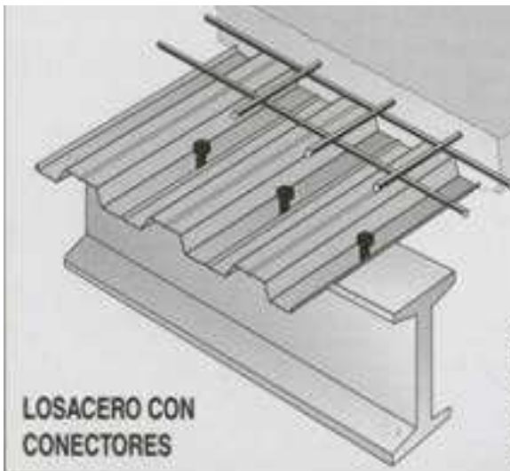
Imagen 95 Detalle Constructivo Losacero
