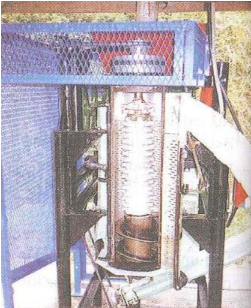
DESMULCILAGINADORA DE TIPO ASCENDENTE (FOTO 18) (Distribuidora Becasa, Guatemala)
