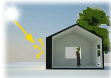
Imagen 14. Muros ciegos Este y Oeste para evitar el soleamiento directo. Tomado de: VALLE, Herbert, Tesis FARUSAC 2010.
