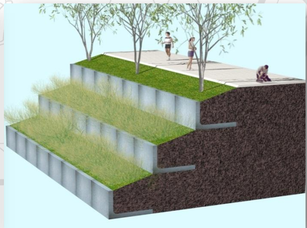
Ilustración 4. Talud escalonado. En sitio web http://community.benchmarkemail.com
