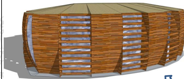
Muros curvos en ambos sentidos en el templo
