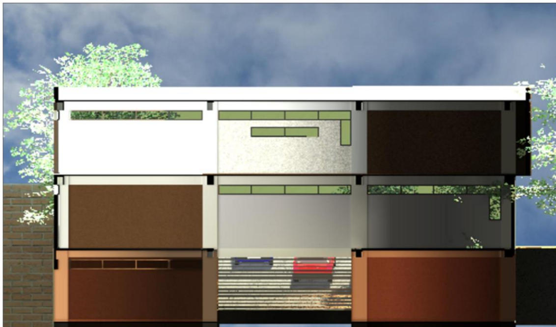
Sección transversal módulo administrativo
