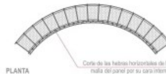
Fotografía # 48 Muros Covintec FUENTE: Multidisciplinas, CR 2014
