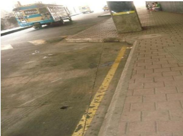
La fotografía muestra un detalle del área para que los usuarios puedan abordar el bus. La circulación de los buses es por ejes longitudinales donde ingresan y egresan por una calle de 8m de ancho, en un carril circulan los buses y en el otro carril se estacionan para que los pasajeros desciendan o aborden las unidades.
