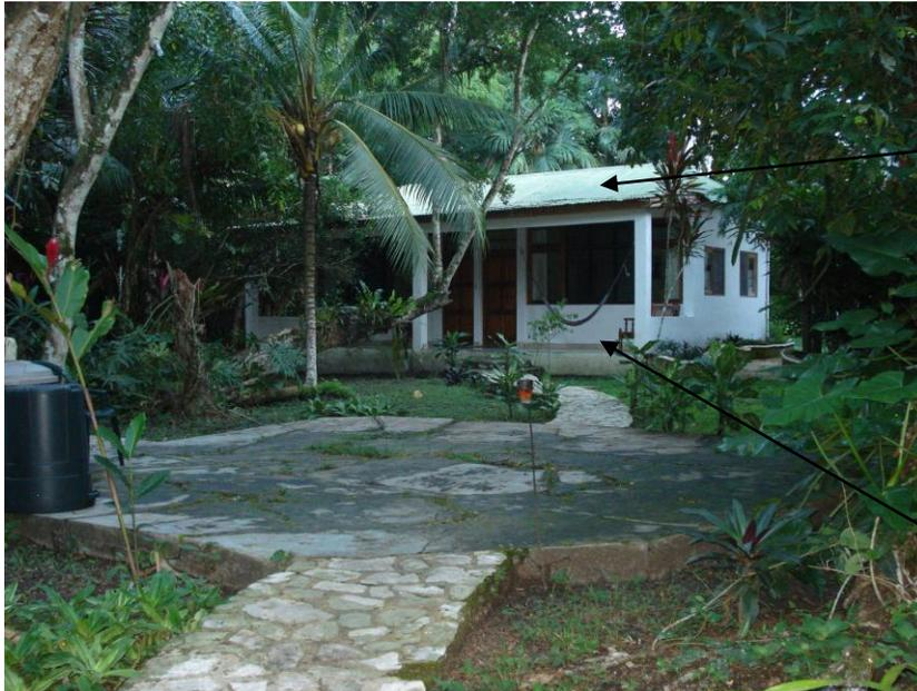
El techo a cuatro aguas, estructura de madera con cubierta de lámina de cinc con cielo falso de tabla yeso, las puertas de madera de caoba para las ventanas de tipo persiana, vidrio y aluminio.
