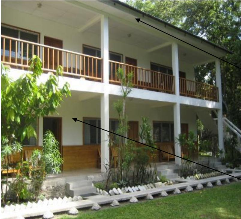
Para el techo a dos aguas, estructura de madera con cubierta de lámina de cinc con cielo falso de tabla yeso, las puertas de madera de caoba para las ventanas continúan de tipo paletas y vidrio y aluminio.
