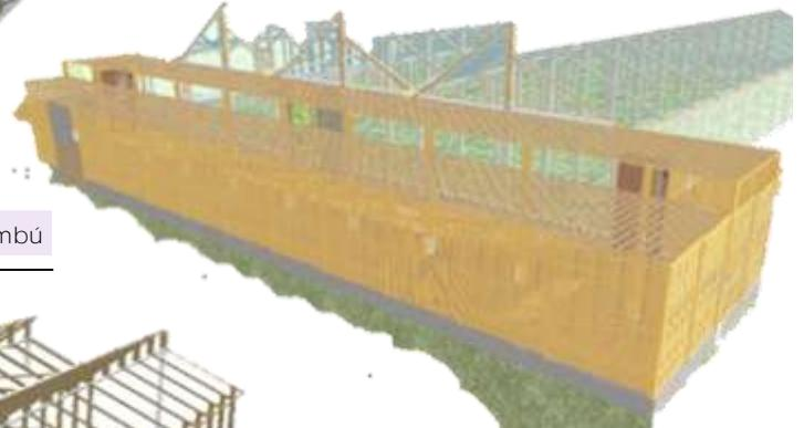
Su forma gótica permite un mayor volumen de aire y una mayor resistencia a la lluvia, además de reducir de forma considerable el problema de la condensación y la caída de gotas de agua sobre cultivos.
