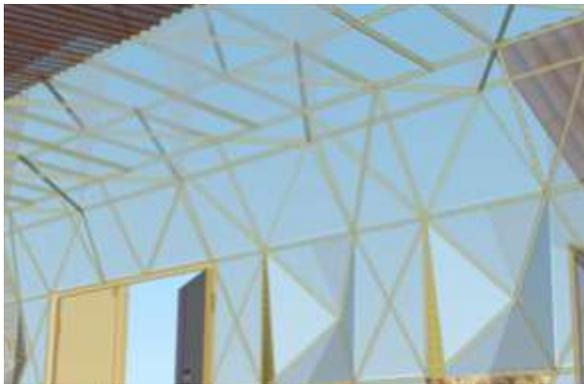
Estructura de bambú utilizada en área de empaque y bodega de fertilizantes, tipo riostras de un ancho de 3 metros con intersección de bambú que ayudan a su estabilidad.
