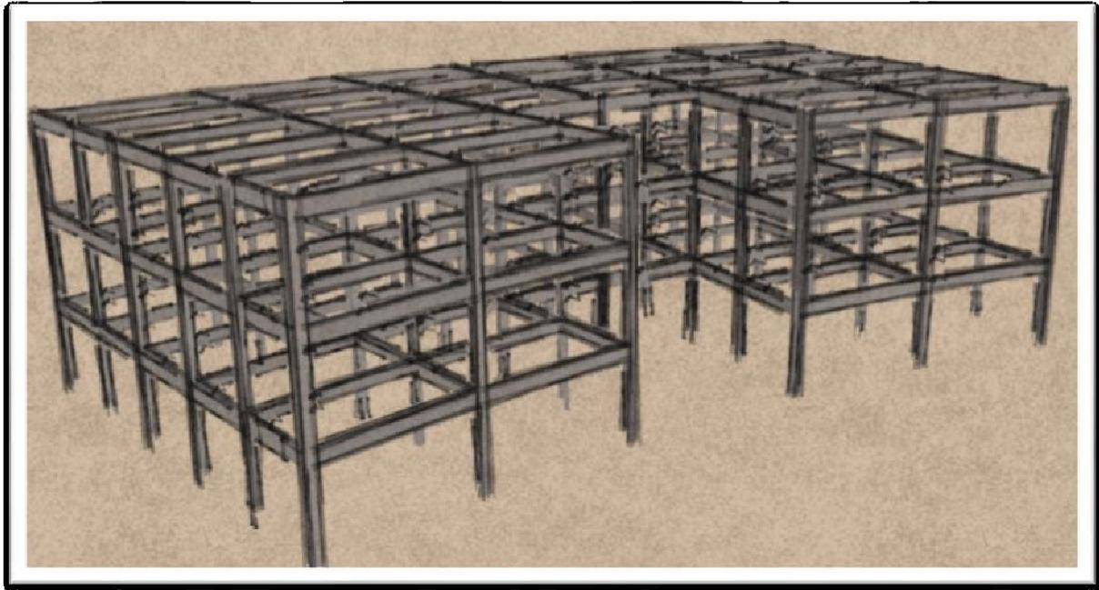
Estructura con marcos rígidos de concreto reforzado. Cada nivel con una altura de 4 m.
