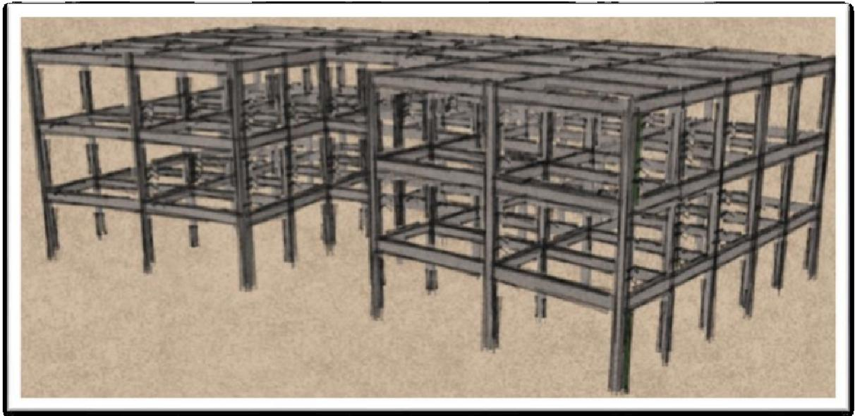
Estructura con marcos rígidos de concreto reforzado, con luces de 4.30 hasta 8.40
