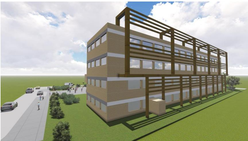
En el edificio de encamamiento, todas las ventanas de los cuartos de recuperación están orientadas al sur y la incidencia solar es directa a los pacientes, por lo tanto se implementa parteluz en toda la fachada SUR de una estructura expuesta conformada por marcos y dinamismo en su colocación por niveles.
