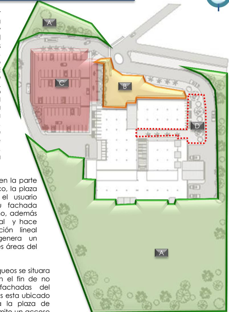
**D SISTEMA CERRADO:** se utilizara una plaza intermedia entre 2 módulos del hospital pediátrico, para generar iluminación y ventilación natural a los ambientes internos del hospital. Además de que se interconectarán ambos módulos a través de este espacio, Los edificios y la circulación vehicular definen el sistema utilizado.
