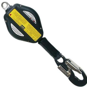
Un dispositivo anticaídas retráctil es un dispositivo con una función de bloqueo automático y un sistema automático de tensión y de retroceso para el elemento de amarre. Puede llevar incorporado un elemento de disipación de energía.
