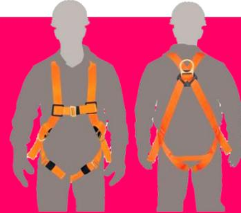
Los sistemas de sujeción en posición de trabajo están destinados a sostener al trabajador en altura y NUNCA deben utilizarse para la parada de las caídas. Hay que recalcar que un cinturón, con o sin elementos de amarre incorporados, no protege contra las caídas de altura y sus efectos. Un sistema Anticaída consta de un arnés, un componente de conexión, y un elemento de amarre.
