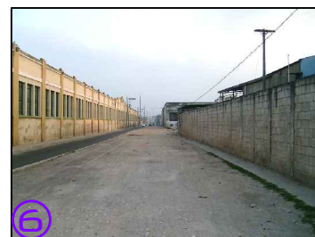
IMAGEN DE ELABORACIÓN PROPIA. SE VISUALIZAN EL ANCHO DE LA AVENIDA FERROCARRIL, EL CUAL ES DE 8.50MT DE ANCHO.
