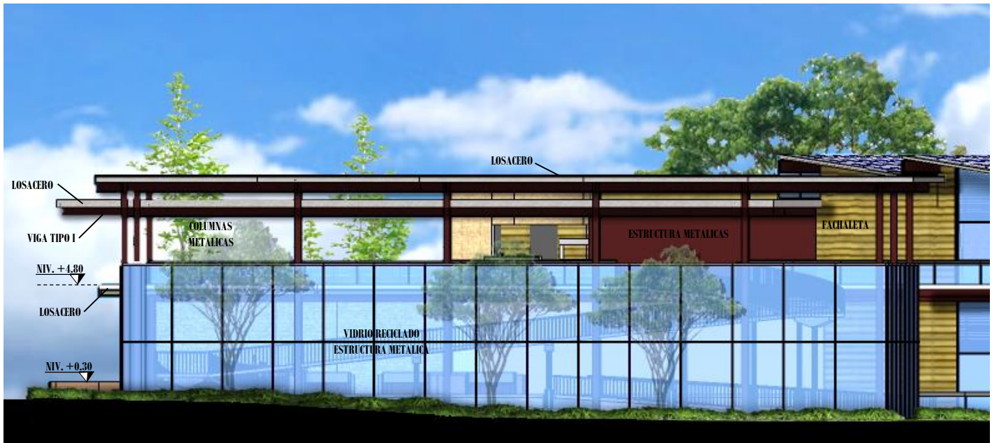
--- ELEVACIÓN OESTE, EDIFICIO ESC: 1:200 ---
