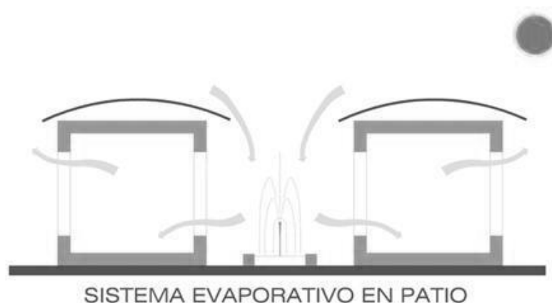
Figura 22. Enfriamiento por ventilación
