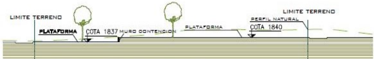
SECCION A-A' PERFIL MODIFICADO
