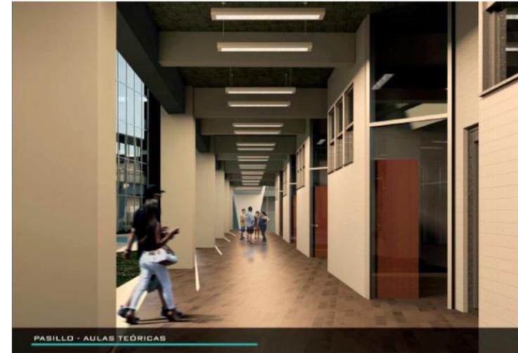
En esta vista de un pasillo típico del edificio de aulas teóricas se puede apreciar la iluminación adecuada que tienen, además de contar con alturas de 4 metros entre pisos para beneficiar la ventilación natural, y el confort climático.
