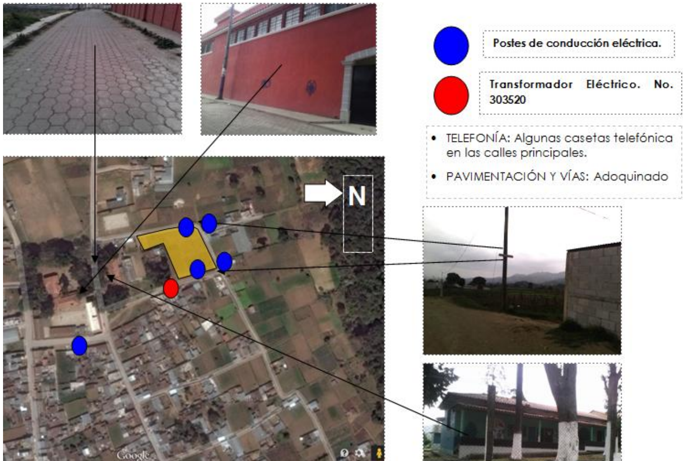
Figura 6.4: Ubicación de Postes de conducción Eléctrica, www.googlemaps . Imagen Satelital
