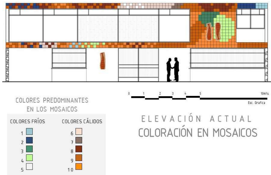
Figura 89. Edificio actual, elevación sureste, despacho de Jorge Montes.
