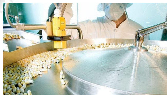
Imagen 2.6- Proceso de Fabricación de Medicamentos. Campana vibradora de comprimidos
