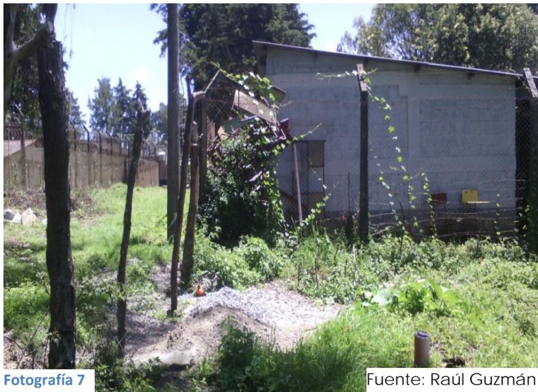
En el sector tanto dentro y fuera de las colindancias del terreno, predomina la construcción con muros de mampostería y acabado de pintura sin repello, techo de una y dos aguas con lámina de zinc, sostenido con vigas de perfile de acero. También existe una construcción provisional que resulta como un aula
