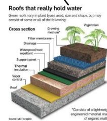
DETALLE CONSTRUCCION TERRAZA JARDIN
