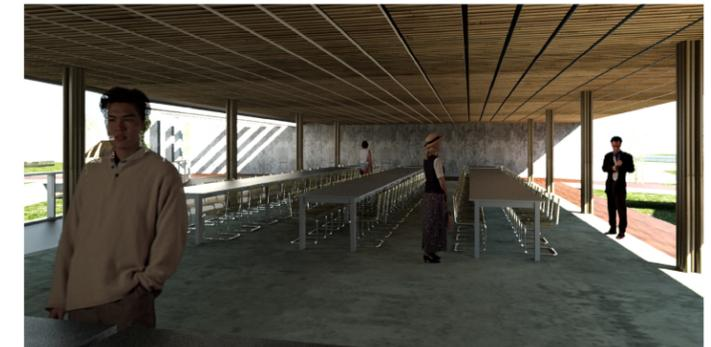
Vista del comedor, con cielo falso de esterilla de bambú, esta doble piel permite el aislamiento térmico proveniente de la cubierta.
