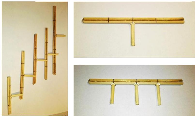
Figura 128 Proceso de armado de viga.
