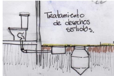
Debido a la falta de drenajes en la comunidad, el proyecto contará con un sistema de tratamiento de aguas residuales y desechos sólidos a base de biodigestores prefabricados.
