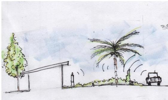
Se diseñarán elementos arquitectónicos y barreras vegetales, que disipen el sonido producido en el edificio viaje al exterior y viceversa.
