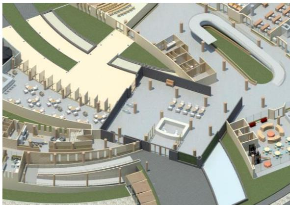
El proyecto sigue las normas de diseño según CONADI y NRD2 procurando una "arquitectura sin barreras" con las circulaciones accesibles para personas con discapacidad, ambientes con áreas de uso adecuadas, conservando circulaciones lineales y amplias, salidas de emergencia, rampas peatonales, puntos de reunión y lugares seguros.
