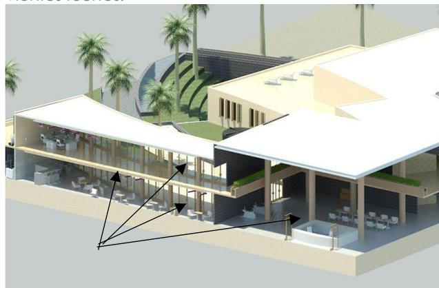
Utiliza materiales para muros y suelos ligeros de corto tiempo de transmisión térmica como madera reciclada de tarimas Pallet, en muros, entepiso y plazas.
