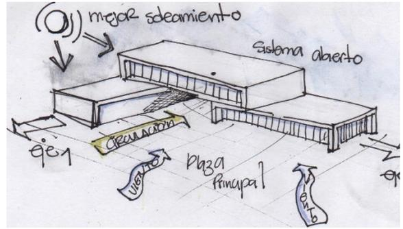
El diseño se desarrollara sobre 2 ejes en sistema abierto para conseguir buena iluminación y ventilación, a la vez que separa funciones de las diferentes áreas de trabajo.
