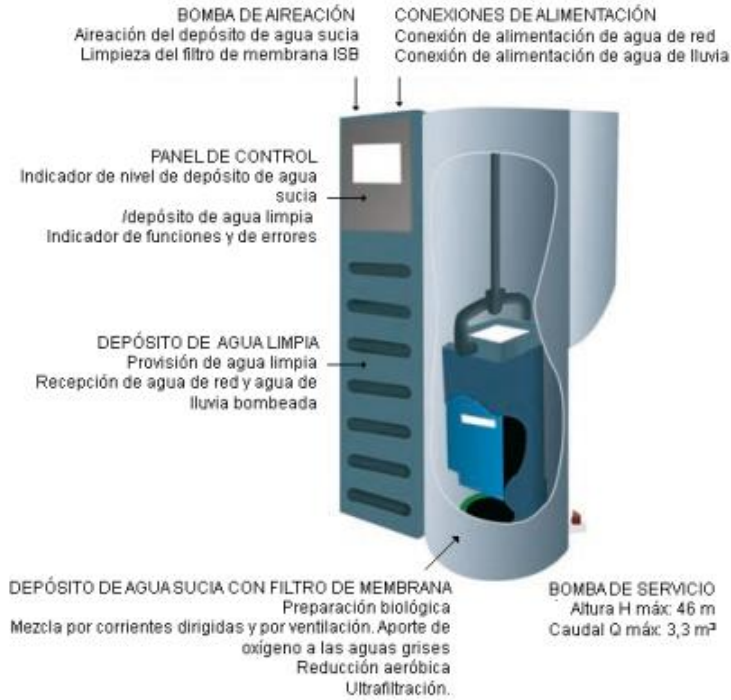
Figura 1. Sistema de filtración mediante membranas
