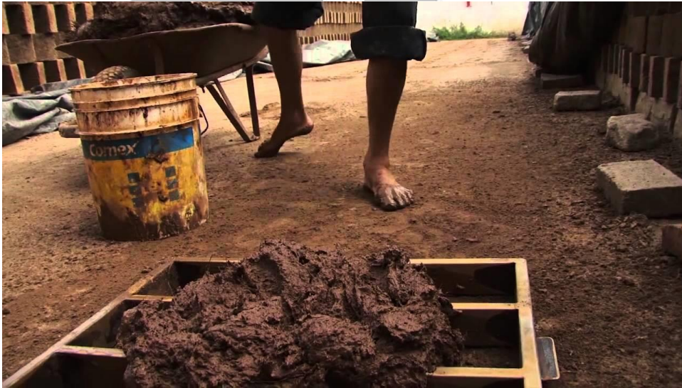
Elaboración artesanal de bloques de construcción. Imágenes online tecpan Chimaltenango Guatemala.
