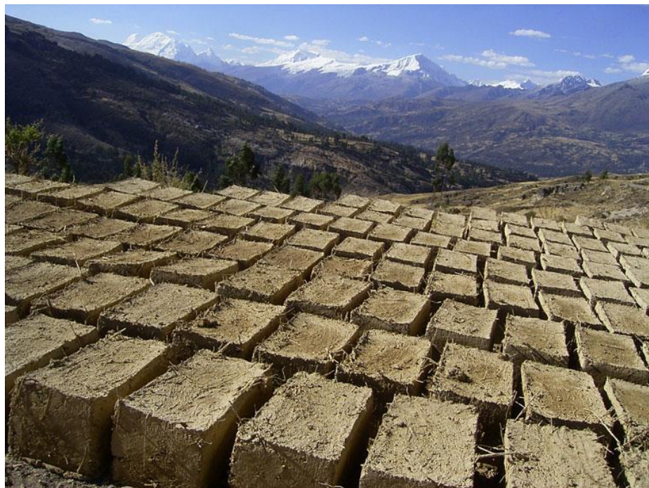
Elaboración artesanal de bloques de construcción. Imágenes online tecpan Chimaltenango Guatemala.
