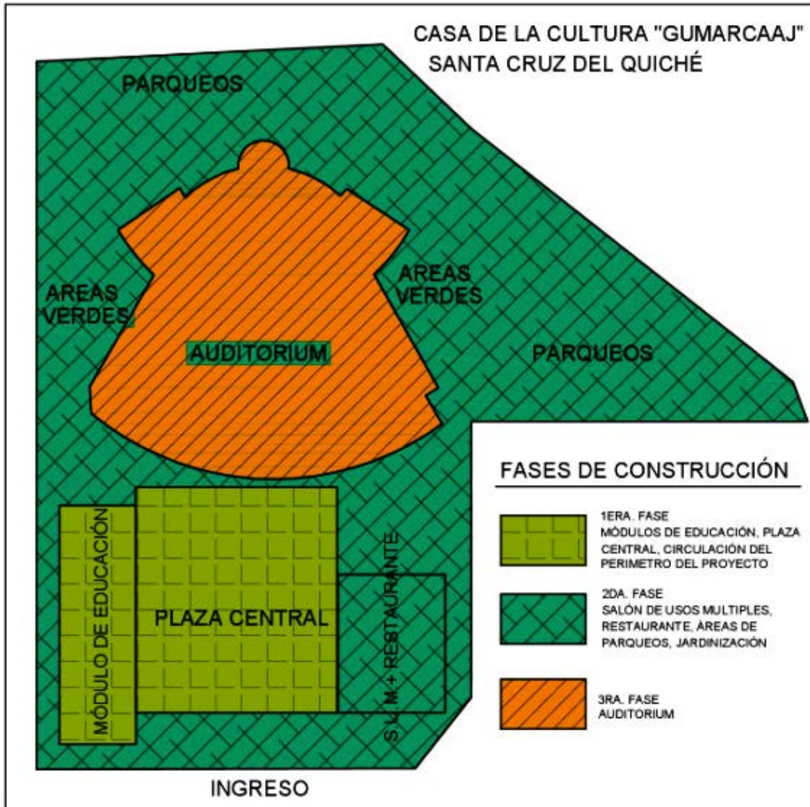
Figura 12 fases de construcción
