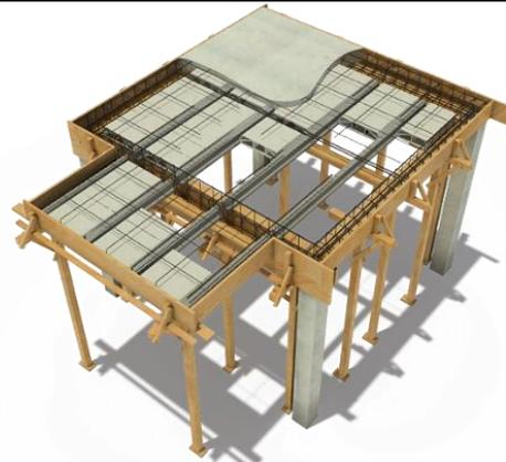
Figura No. 49 Sistema constructivo en techo Fuente: <http://www.vipret.org/>
