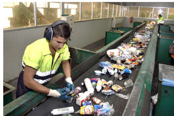
Imagen 26. Cinta de Clasificación manual de residuos solidos Fuente. www.ceamse.gov.ar
