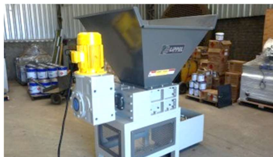
Imagen 29. Máquina trituradora de residuos sólidos. Fuente. www.ceamse.gov.ar
