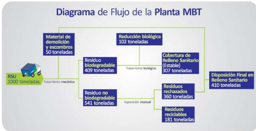
Grafica 4. Diagrama de flujo de la Planta de Tratamiento Biológico, Buenos Aires, Argentina. Fuente: www.ceamse.gov.ar
