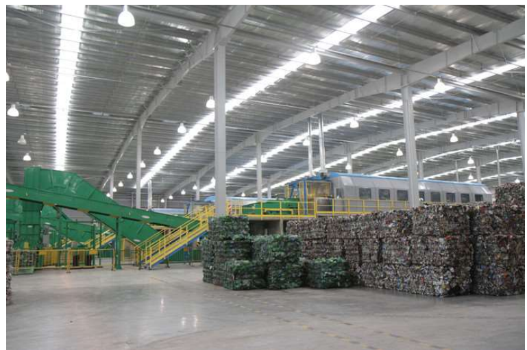
Imagen 11. Áreas de compactación de residuos sólidos reciclables previo a embalaje y comercialización. Planta de tratamiento Biológico, Buenos Aires, Argentina. Fuente: ceamse.gov.ar
