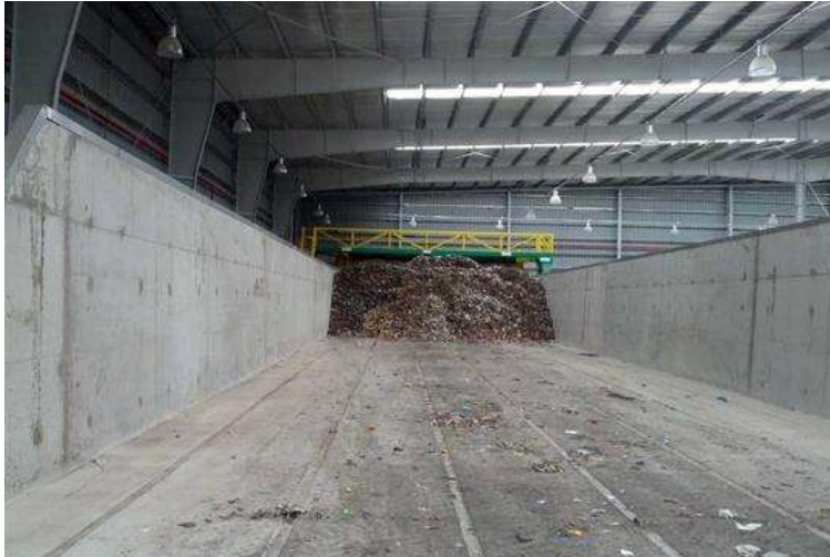
Imagen 10. Áreas de Almacenamiento de residuos sólidos, previo a su clasificación y posterior tratamiento. Planta de tratamiento Biológico, Buenos Aires, Argentina. Fuente: ceamse.gov.ar
