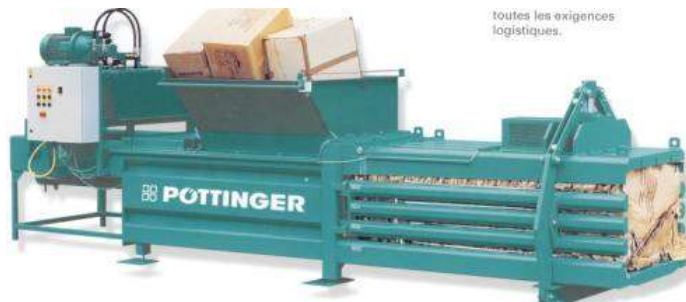
Imagen 28. Maquina compactadora de residuos sólidos reciclables / cartón y papel. Fuente. www.ceamse.gov.ar
