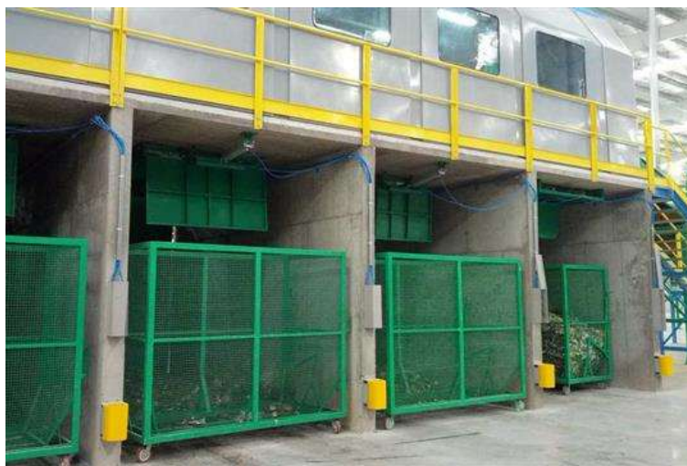
Imagen 12. Áreas de almacenamiento de residuos sólidos reciclables y no reciclables, posterior a ser clasificados mediante la cinta de clasificación manual. Planta de tratamiento Biológico, Buenos Aires, Argentina. Fuente: ceamse.gov.ar
