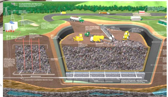
Imagen 9. Funcionamiento de Relleno Sanitario Planta de tratamiento biológico. Buenos Aires, Argentina. Fuente: ceamse.gov.ar
