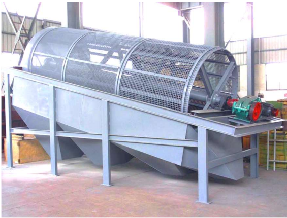
Imagen 31. Fotografía de trommel mecánico. Fuente. www.ceamse.gov.ar
