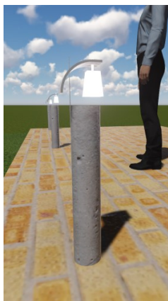
LÁMPARAS EXTERIORES DE ILUMINACIÓN INDIRECTA, UBICADAS SOBRE LOS CAMINAMIENTOS QUE COMUNICAN LAS DIFERENTES ÁREAS
