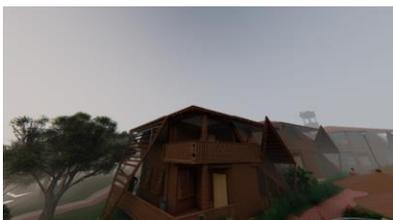
Tanto las cubiertas como las estructuras de madera buscan aislar la radiación solar, en el frente se implementó una sobre cubierta que permite generar en el interior una estructura de madera más cedazo, a la cual no le llegara el agua y permanecerá una fresca en el interior.
