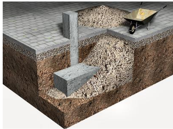
Imagen 27. Gráfica de relleno controlado. (www.generadordeprecios.info)
