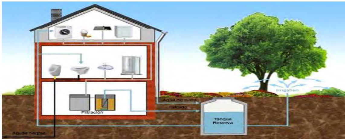
IMAGEN 8: SISTEMA DE AGUA POR GRAVEDAD
