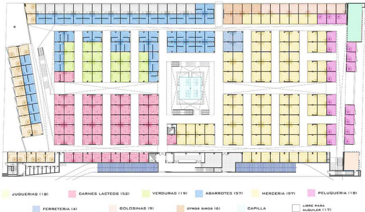
El primer nivel cuenta con 297 locales, además se puede acceder desde los cuatro extremos del edificio, una capilla al centro, circulación vertical en tres puntos distribuidos en diagonal con dos ductos en los extremos y uno en el centro y los pasillos son lo suficientemente anchos para una circulación cómoda a lo largo del todo el recorrido, sin embargo, no se observan baterías de baños en dicha planta que sean de fácil acceso, sobre todo para las personas con ciertas capacidades especiales.
