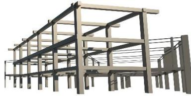
Usar Sistema de Marcos rígidos de concreto reforzado en estructura principal del edificio.
