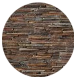
FACHALETA DE PIEDRA PARA FACHADAS DE EDIFICIO MUNICIPAL Y SALÓN DE USOS MÚLTIPLES
