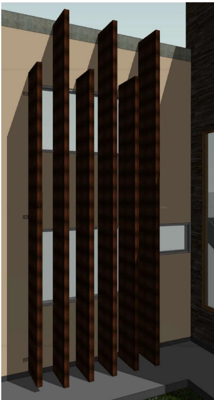
DETALLE PARTELUCE PARA PROTECCIÓN DE LA LUZ SOLAR DIRECTA DENTRO DE LOS AMBIENTES
