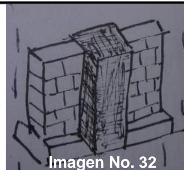
Para lograr la estabilidad lateral en los muros de carga, se manipulará su plan geométrico con la adición de una aleta perpendicular aumentando su resistencia en ese sentido.
