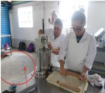
**Fotografía No. 24** Pisos se observan en el área de trabajo que son de concreto sin ninguna protección y son contaminados con todos los objetos que se encuentran en cualquier área del lugar.
