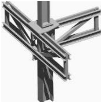
Unión de vigas sobre una columna de Perfil H.
