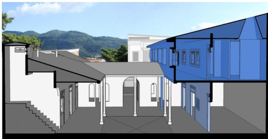
**Figura 123.** Sección transversal en perspectiva que muestra la ampliación de la crujía poniente a dos niveles para preservar la relación de la casa con el paisaje del Cerro San Jacinto al suroriente.
