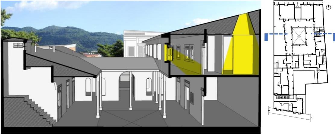
**Figura 126.** Sección transversal en perspectiva que muestra iluminación de los espacios a través de los tragaluces ubicados en la estructura de techo y las aberturas del muro exterior del corredor.
