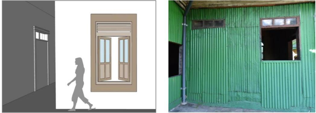
**Figura 129.** (Izquierda) Integración de nuevo diseño de ventana reinterpretando los vanos existentes (derecha) y las ventanas del 2º nivel de la crujía principal que se componen de dos hojas abatibles, principio que ha sido retomado para la nueva propuesta. La diferencia con los originales está en el marco grueso sin molduras que rodea el vano.
