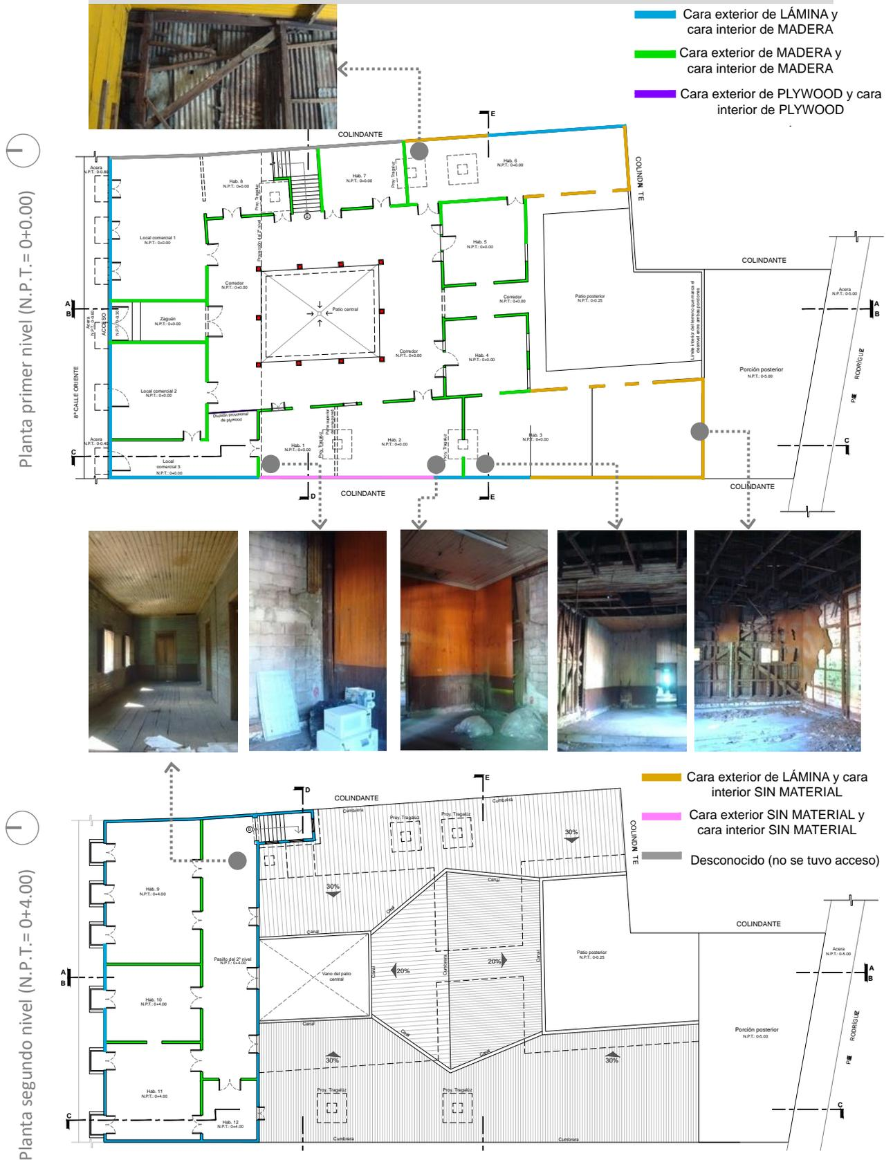
**Figura 71.** Planos de materiales en paredes del 1º nivel (arriba) y del 2º nivel (abajo). Sin escala
