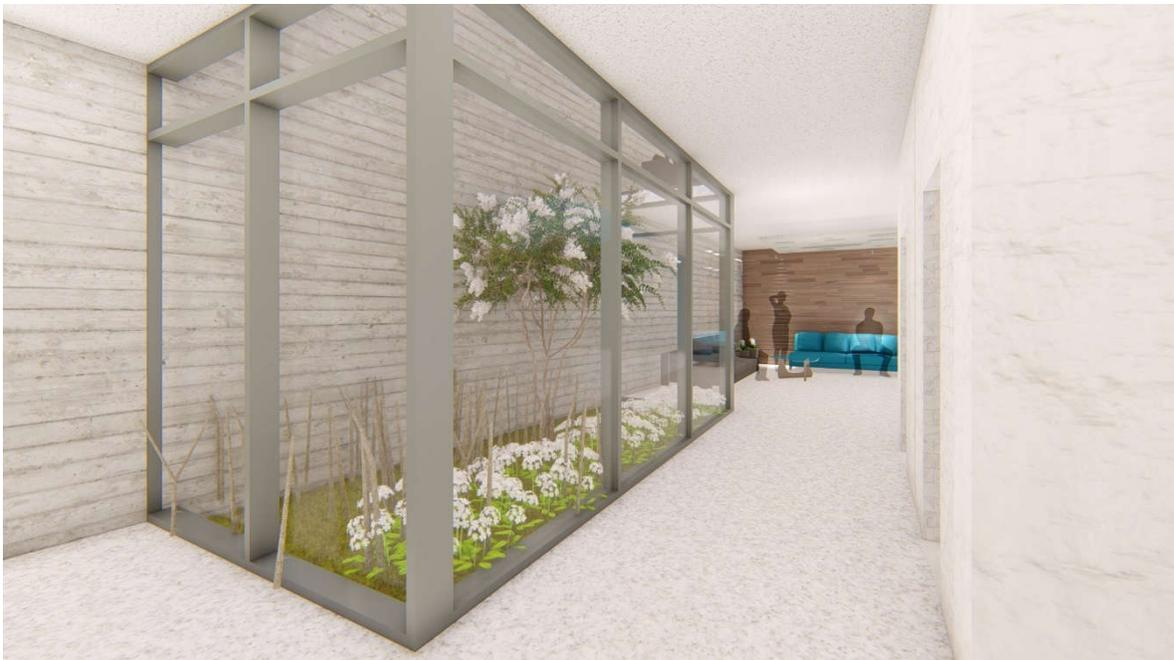
Se ilumina y ventila cada uno de los módulos de circulación mediante un cubo acristalado de muro cortina, el cual contiene vegetación del lugar.
