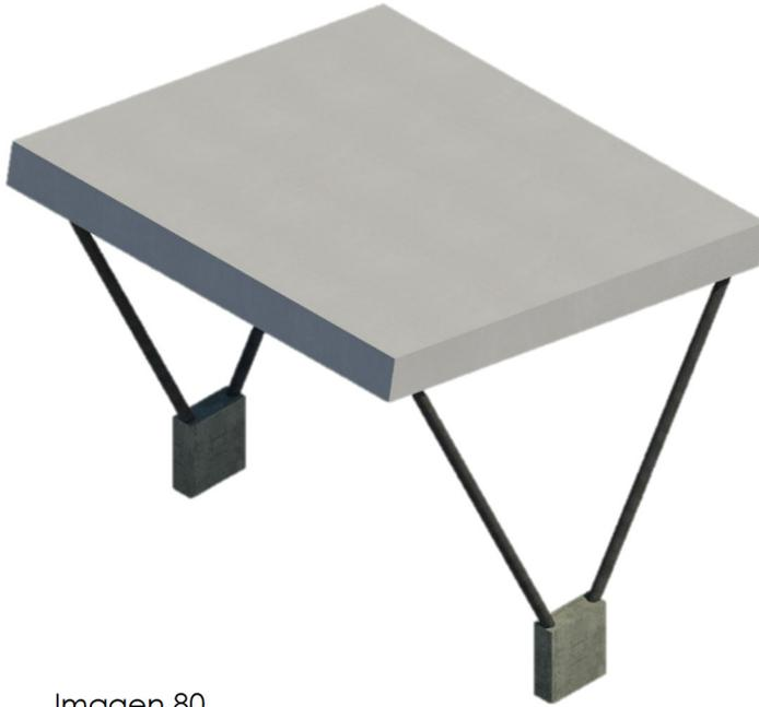
Se utilizara estructura metálica desmontable de tubos galvanizados, este tipo de estructura se colocara en bases de concreto para su estabilidad. Como techo que utilizara tela tipo lona como la utilizada en toldos.
