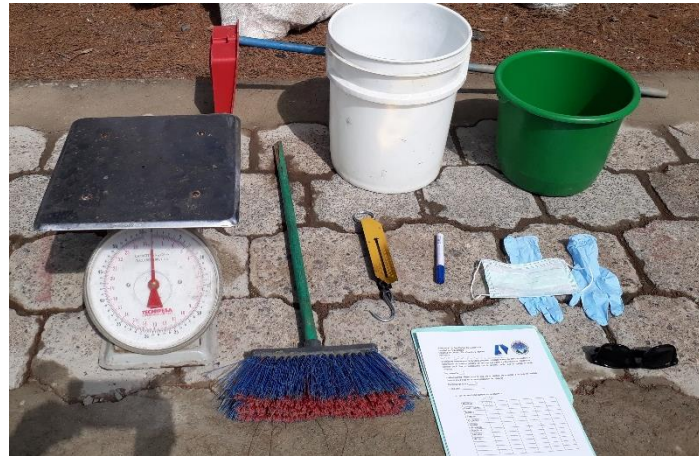
Figura 22 equipo utilizado para la caracterización de residuos sólidos
