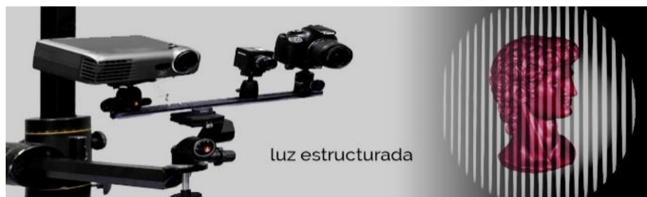
Ilustración 32 Equipo y proyección de luz estructurada para escaneo de objetos.
