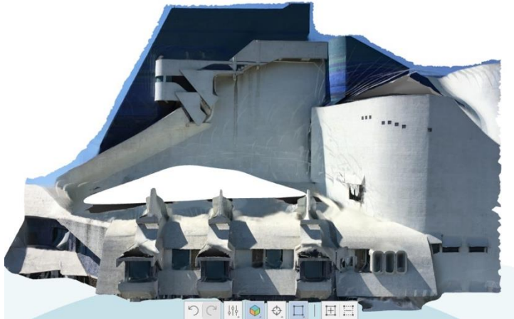
Ilustración 67 Modelo virtual creado con fotos de un celular.
