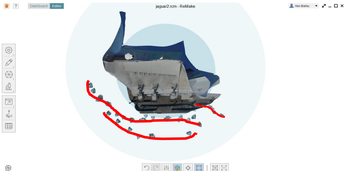
Ilustración 76 Las líneas rojas indican las posiciones en que se realizaron las fotografías y su relación con el edificio.
