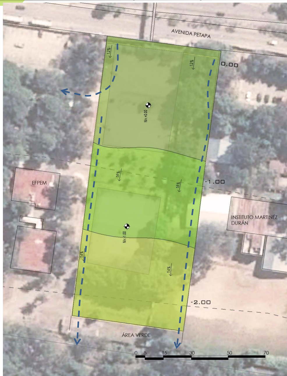
Figura 115 Zonificación de pendientes y escorrentías
