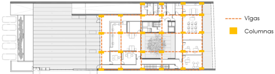
Figura 51 Análisis de modulación estructural
