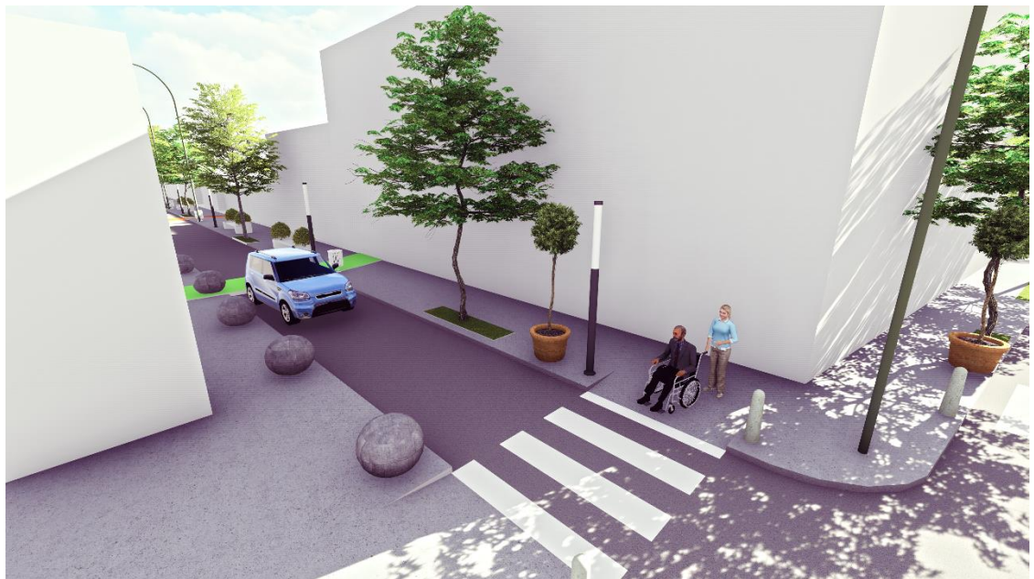
BOLARDOS, SEÑALIZACIÓN HORIZONTAL, LUMINARIAS ALTAS, VADOS PEATONALES
